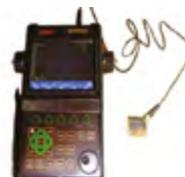
Rilevatore saldature ultrasuoni
